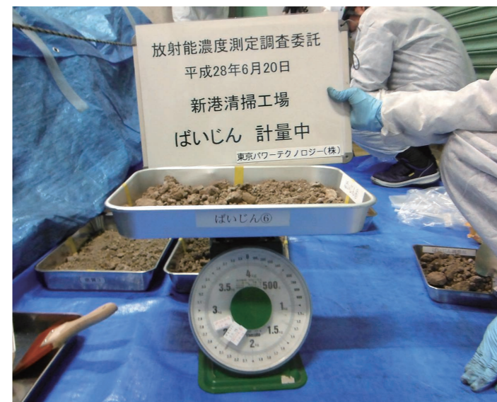
新港清掃工場における放射能濃度測定の様子
